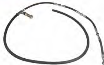
Tubería colector de rebase de inyectores
